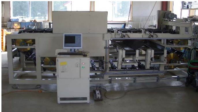
写真1 コンベアを装備した内部品質評価用光センサー コンベア中央のボックスが計測部。手前に制御解析用コンピュータを設置
