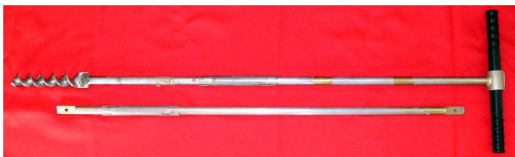
図7 深層土壌採取に用いるスクリュウ型ハンドオーガ （掘削深に応じて、写真下の長さ1mの継柄を連結する）
