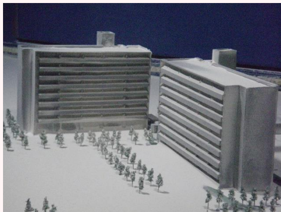
風洞実験による吹きだまり位置の予測
