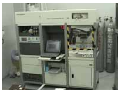
コーンカロリメーター (建築材料の発熱性測定試験機)
