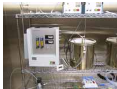
小型チャンバー (ホルムアルデヒド発散量の試験装置)
