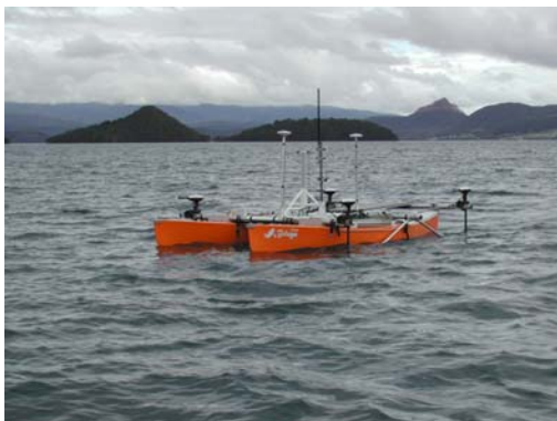
無人測量艇による精密地形測量
