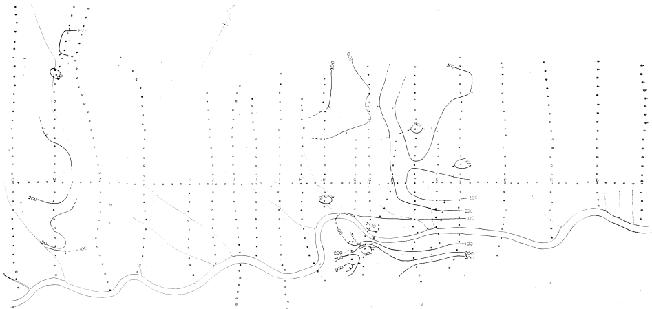
第7図 比抵抗分布図 (a=20 m, 単位 Ωm)
