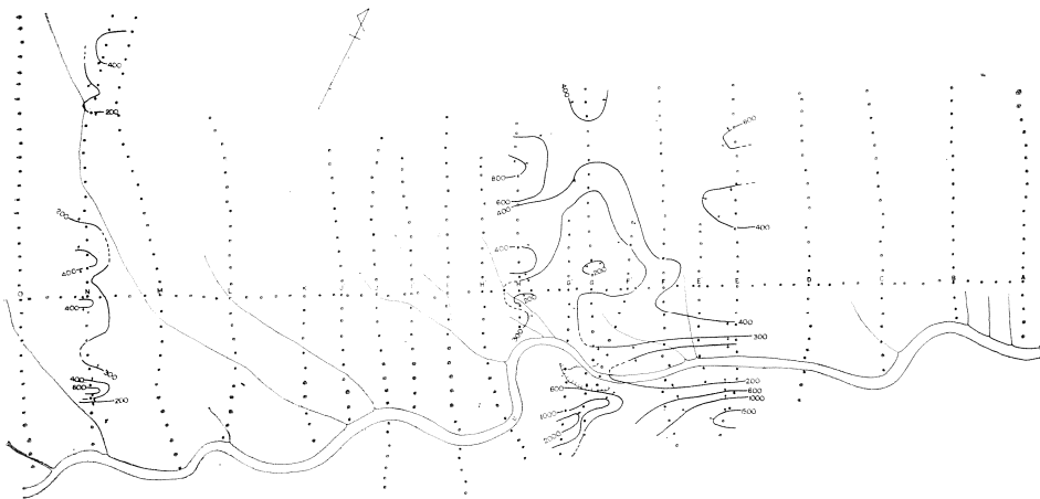
第6図 比抵抗分布図 (a=10 m, 単位 \Omega m )
