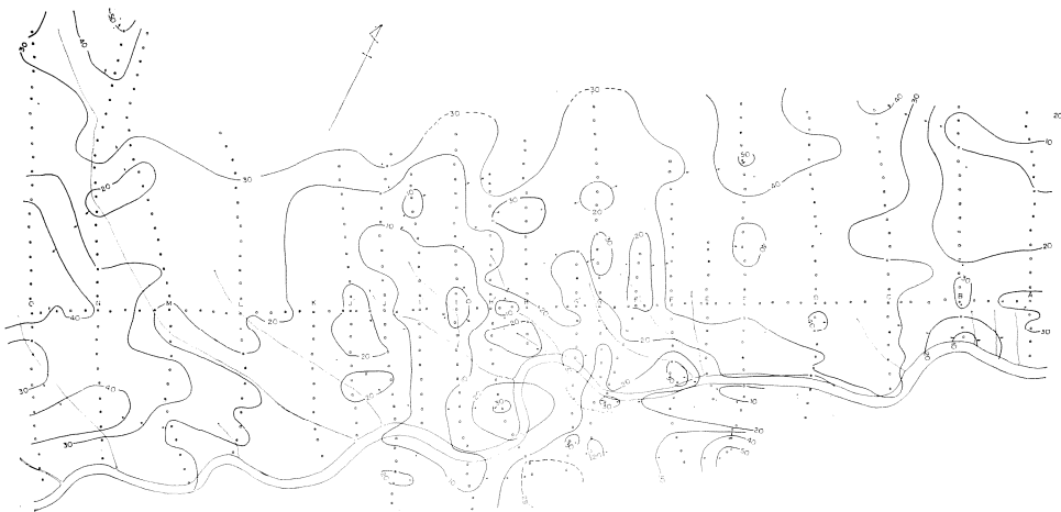
第3図 自然電位分布図 (単位 mV)
