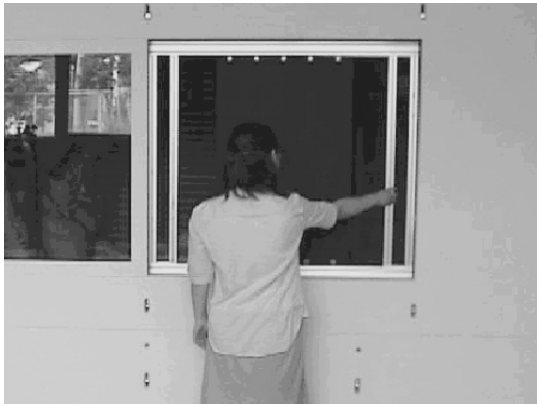
写真2 摩擦力と操作感の試験
