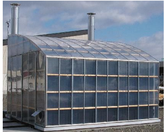
写真 太陽熱木材乾燥装置（南側）
