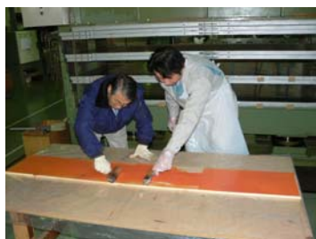
合板の製造（着色済接着剤の塗布）
