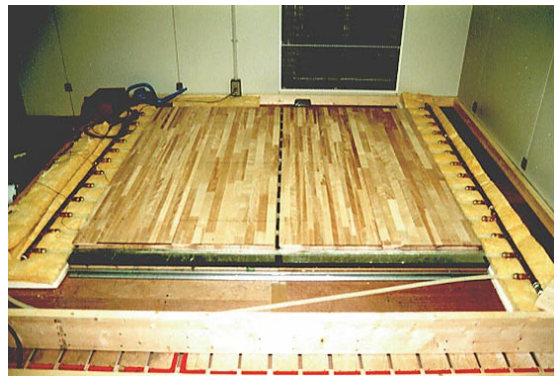
写真3 床暖房用フローリングの耐熱試験
