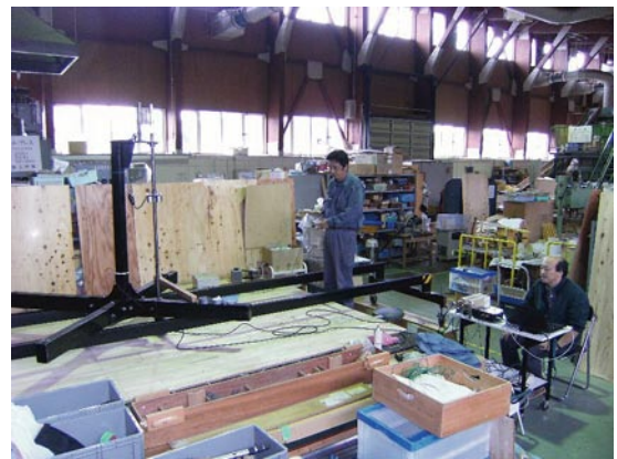
写真2 床の弾力性試験
