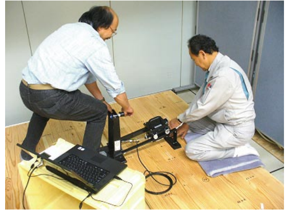
写真1 床の滑り試験
