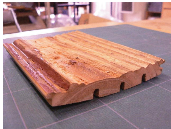
写真5 10年以上屋外使用した外装材
