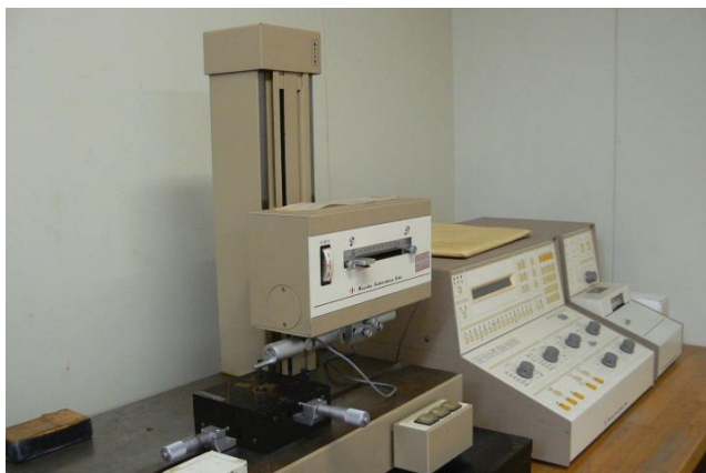
写真1 触針式表面粗さ測定機
