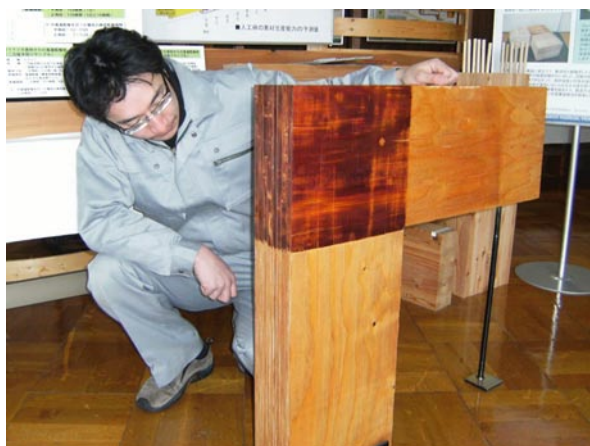
写真1 単板積層圧密接合によるL字形部材
