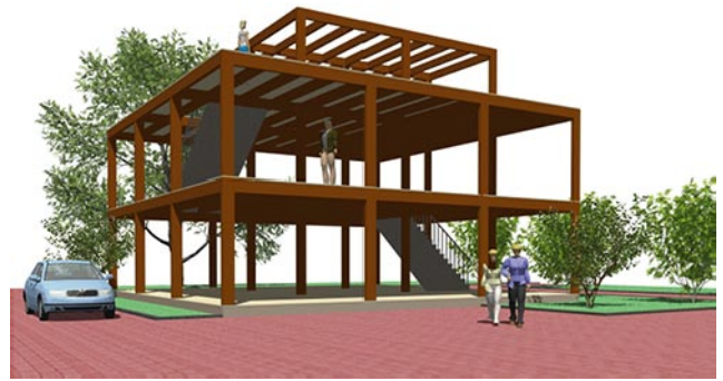
図3 木質フレーム構造の例
