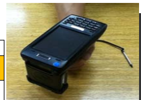
写真1 PDAの外觀 (PDA: ICタグ, QRコード読み取り, 情報転送装置)
