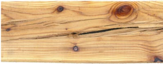
写真3 冷却不足により生じた裂け目
