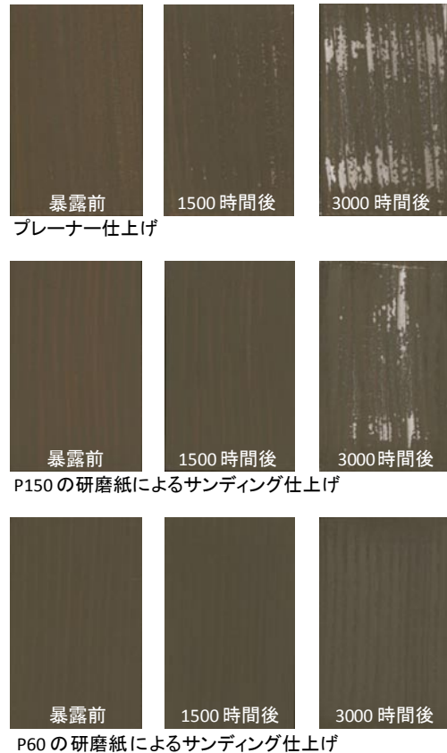
図6 促進耐候処理による外観の変化
