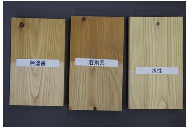
写真5 暴露49日後の試験片(上部:暴露,下部:未暴露)
