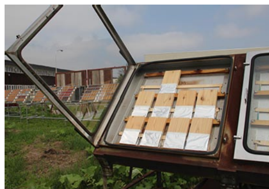
写真3 板ガラスを通過した太陽光に暴露
