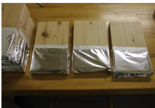
写真1 アルミ箔で被覆した暴露用試験片
