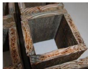
内部断面の腐食状況
