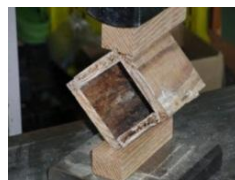
釘の引抜き試験
