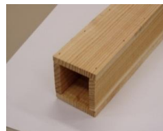
試作の木製暗渠排水管
