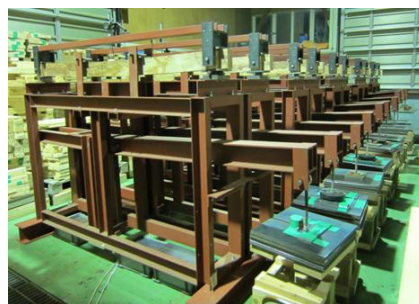
長期荷重試験の様子
