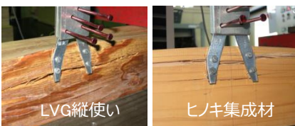
金物接合部の引張試験
