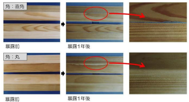
図9 木材の形状と塗膜の劣化速度
