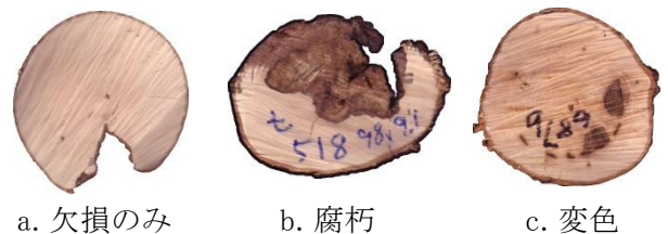
写真3 腐朽等の区分
