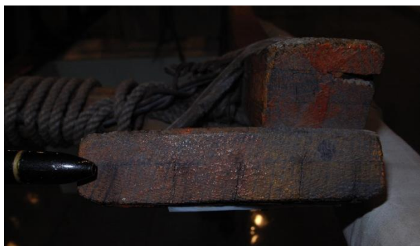
写真2 ラミナを接着して造られた部材
