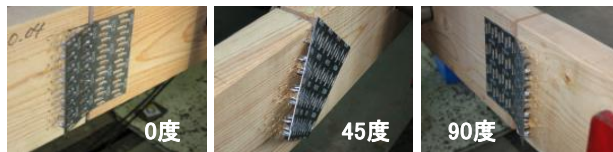
接合部の引張耐力試験
