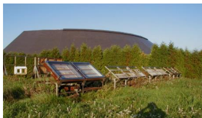
図1 板ガラスを通過した太陽光に暴露
