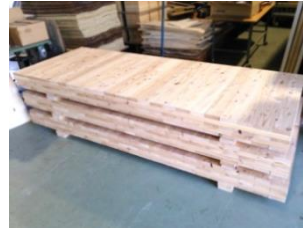
写真1 林産試験場で試作した道産カラマツCLT
