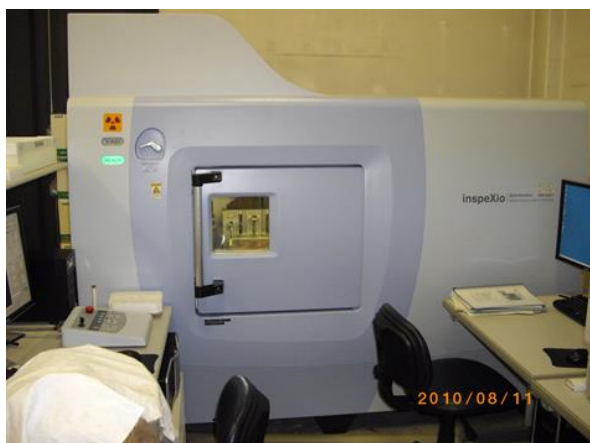
図1 実験に用いたX線CTスキャナー
