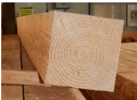
図1 人工乾燥後に大きなねじれが出現したカラマツ材
