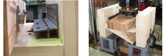
ビスの引抜け CLT内層の割れ 破壊の様子
