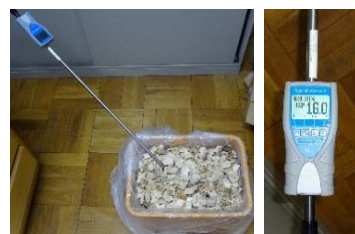
写真1 挿入式水分計による水分測定の様子
