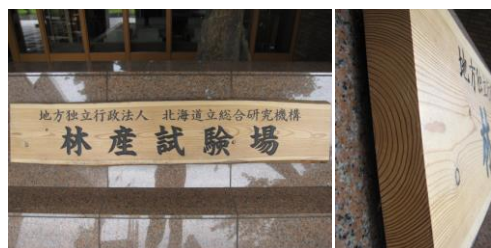
図3 林産試験場の玄関前に設置された看板（基材：カラマツ，設置して5年経過後の様子）
