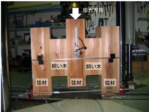
写真4 弦材と飼い木との接合性能試験の様子
