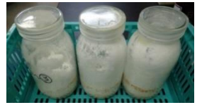
写真3 腐朽菌に暴露した状態
