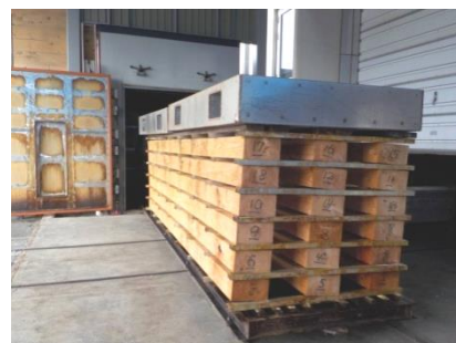
図1 心持ち平角材の乾燥試験
