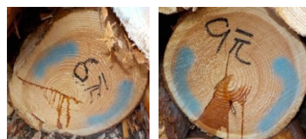
図4 心割れの大きい原木(ヤニの浸出が多い)
