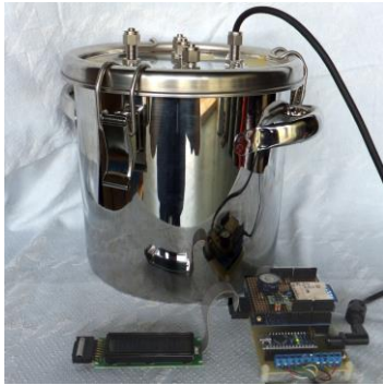
図2 試作した electronic nose
