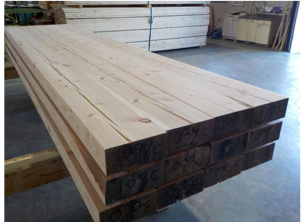
写真4 大きな表面割れが生じた平角材の例
