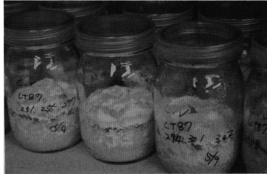
写真1 強制腐朽試験（JIS法）
