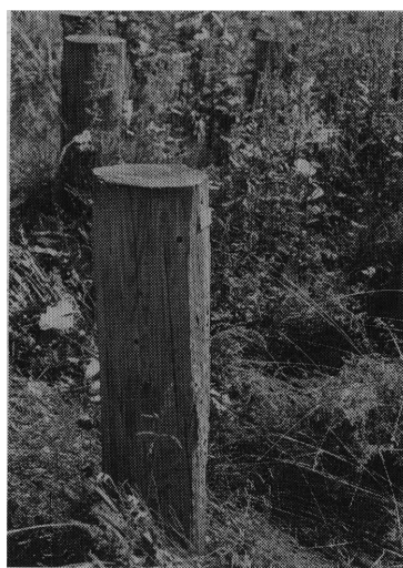
写真2 野外杭試験 (林産試験場内)
