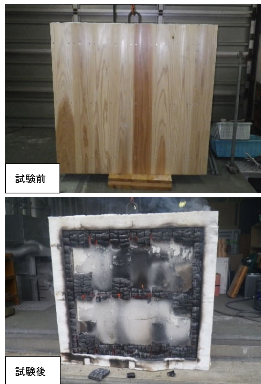
写真1 加熱前後における板材の状態
