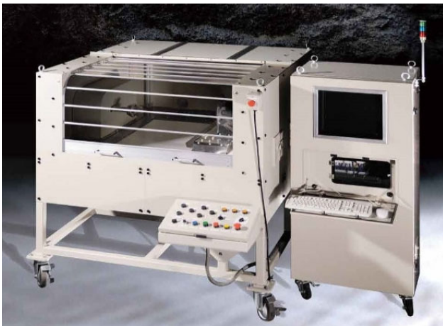
写真1 実用化されたCNC木工旋盤
