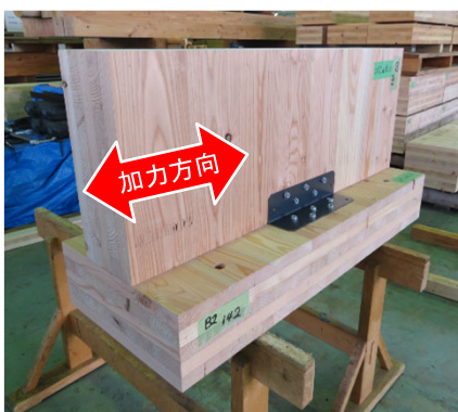
試験体（L型せん断金物）
