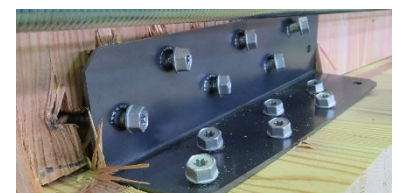
直径8.0mmビス：破断せず
