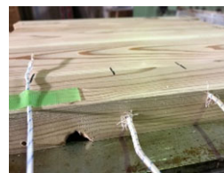
センサーにより製造条件を把握。試験体の内部に埋め込んで温度測定。
