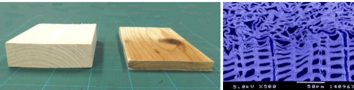
写真左は、圧縮前(左)と圧縮後(右)。 写真右は、圧密化した木材組織の顕微鏡写真。細胞が折りたたまれた状態になる。
