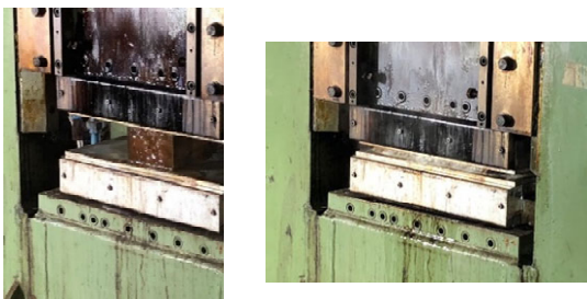
ホットプレスによる圧縮。(左:圧縮前, 右:圧縮後) 原材料の特性をとらえ用途に適した厚さに仕上げる。
