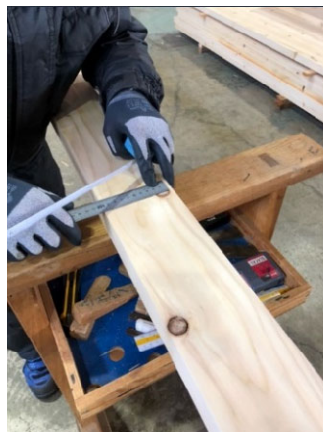
図2 節の場所と大きさを測定
