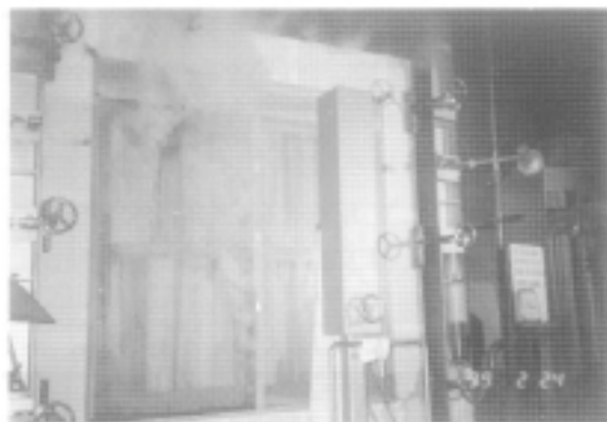
写真3 木製引き戸の耐火試験
