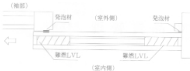
図3 引き戸の防火処理
