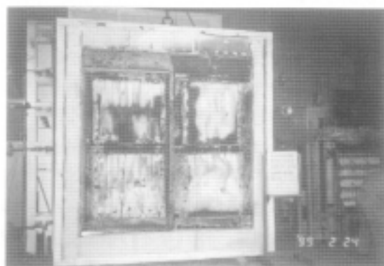
写真4 20分加熱終了後 加熱側の表面材は焼失するが 遮炎性は失われていない
