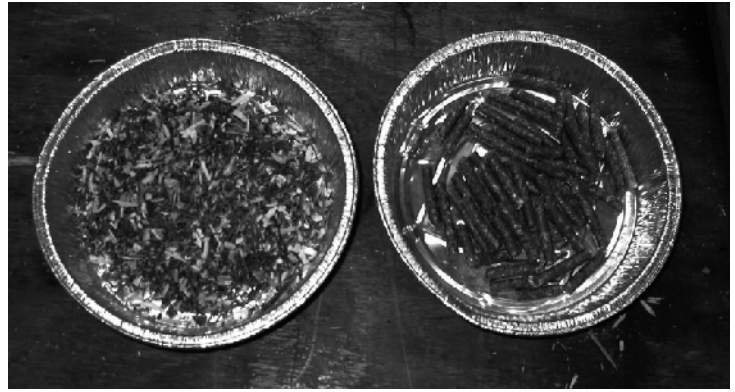
写真2 トドマツ枝条 (枝7:葉3) (左) を原料としたペレット (右)
