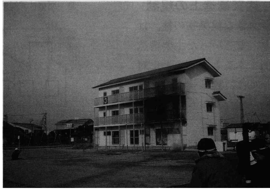
写真 1 木造 3階建住宅の実大火災実験 15分後 1階居間の火盛期 30分後 区画の効果により火勢が劣える 65分後 2階の火盛期 70分経過後に消火したが、3階には延焼せず、倒壊のおそれもない。
