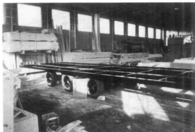
写真2 住宅部分施工前のシャーシ
