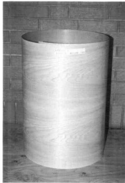
写真1 つき板とグラスファイバー織布を組み合わせた壁材（センつき板）
