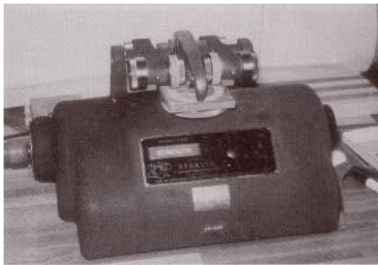
写真1 テーパ式摩耗試験機
