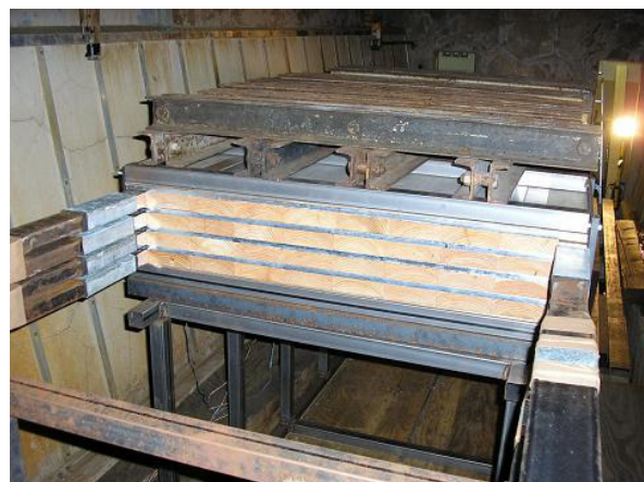
第3図 カラマツラミナの乾燥試験装置
