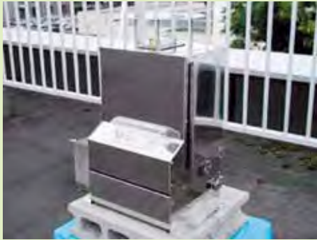
空中花粉を集める機械（ダールム型捕集器）
