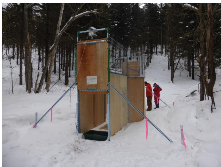
写真-1 北海道立総合研究機構環境科学研究センターが開発した体重計測式小型囲いわな
